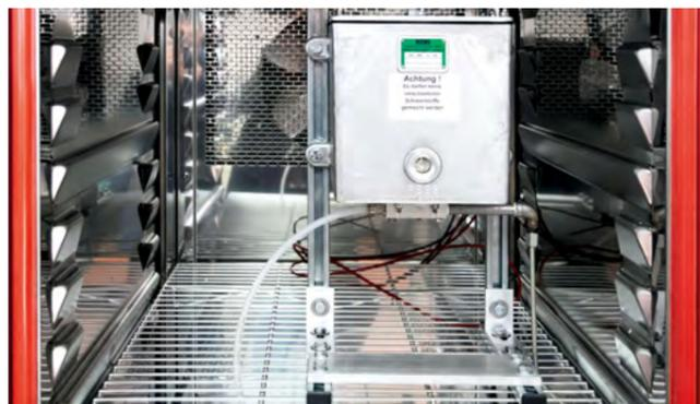
Испытательный стенд смазки реборды бандажа
